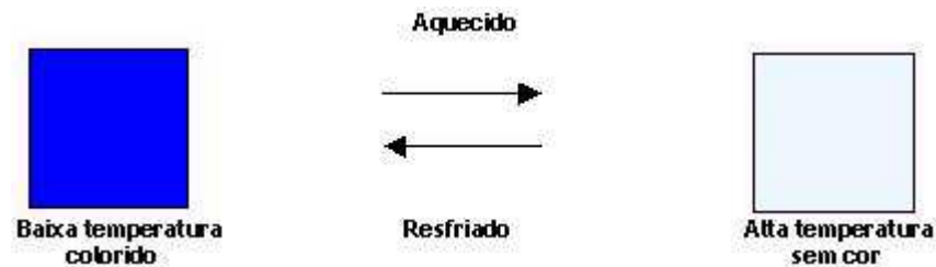
Figura 9 Exemplo de mudança de cor no polímero termocrômico
