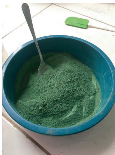
Figura 88: Solo-cimento com pigmento verde.
