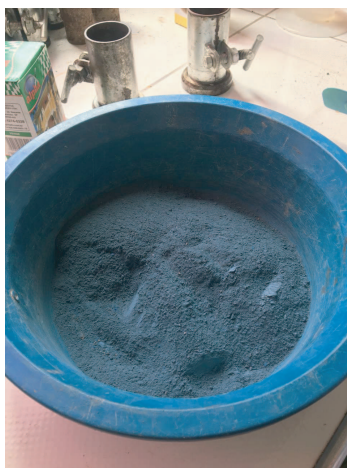
Figura 85: Solo-cimento com pigmento azul.
