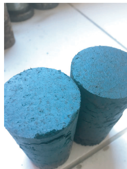
Figura 92: Solo-cimento com pigmento azul.
