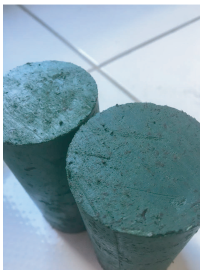
Figura 91: Solo-cimento com pigmento verde.
