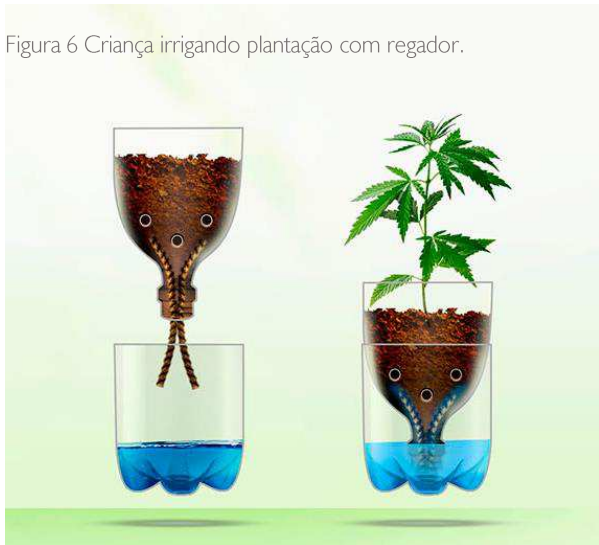
Figura 7 Imagem do sistema de pavio
