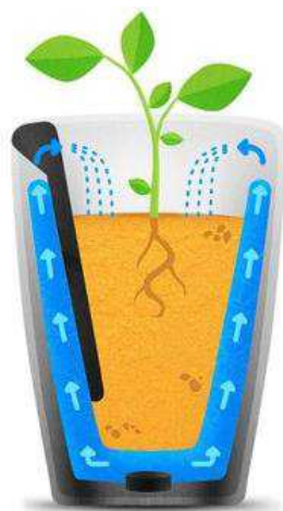
Figura 8 Corte do vaso inteligente Parrot Pot
