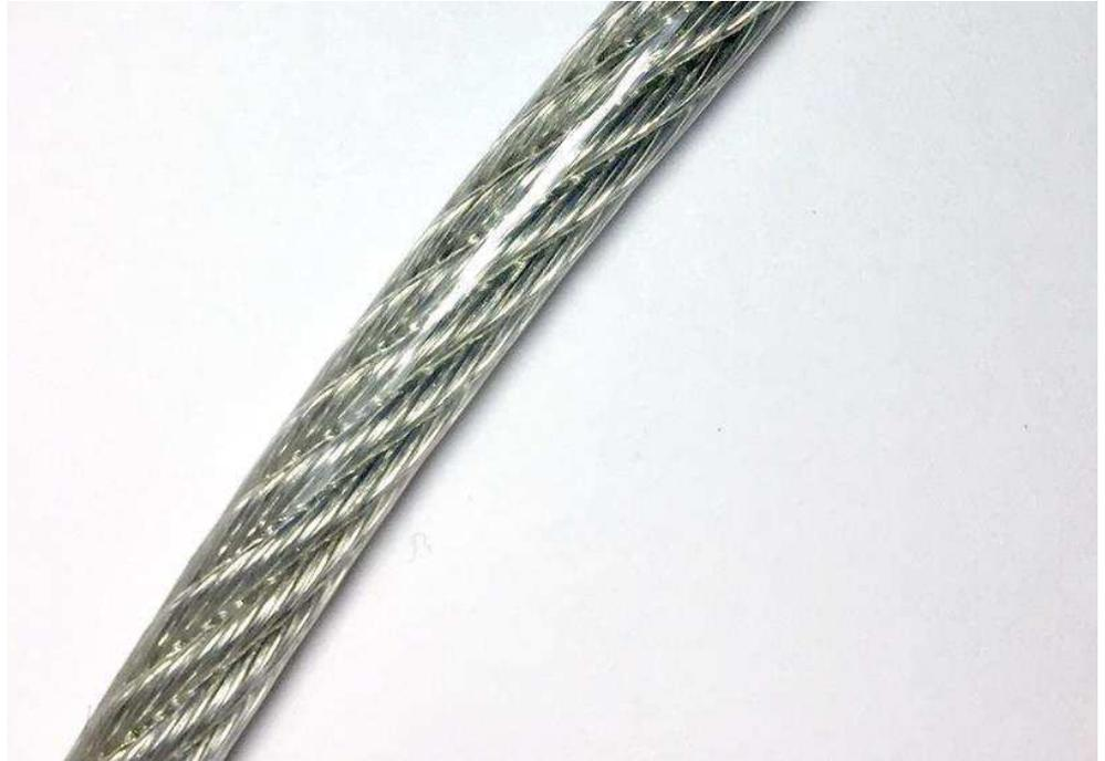
NBR 14350 indica que cabos de aço (revestidos de poliéster) devem ser torcidos e deve-se utilizar grampos para fixação do cabo.
