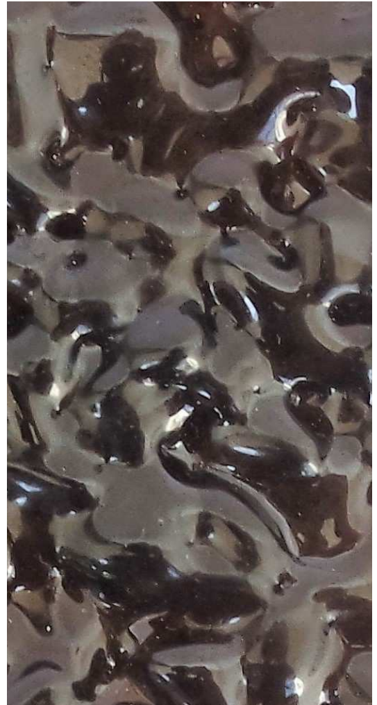
Figura 43: Textura do produto resultante da fundição dos grãos de vidro triturados. Fonte: Acervo da Autora
