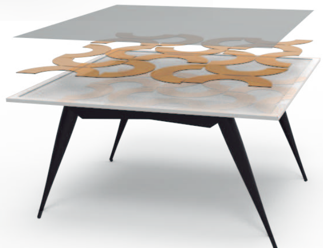
Figura 46: Esquema estrutural da aplicação do produto em uma mesa
