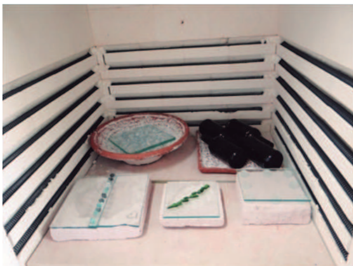
Figura 9: Peças no forno para realização do tratamento térmico
