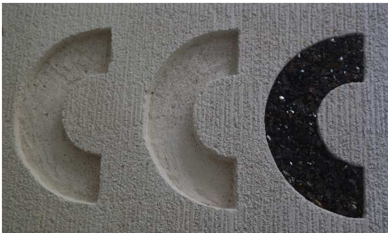
Figura 39: Molde finalizado e preenchido com os grãos de vidro Fonte: Acervo da autora
