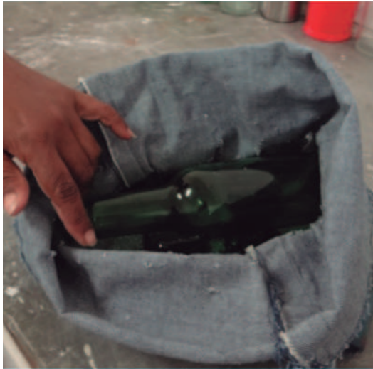
Figura 4 e 5: Trituração das garrafas, podendo ser em sacos de jeans ou na máquina de triturar.
