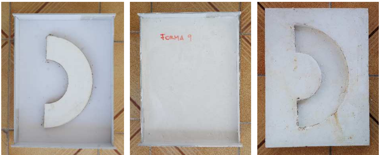
Figura 24: Desenvolvimento do molde de gesso da forma 9.
