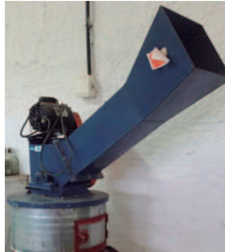
Figura 4 e 5: Trituração das garrafas, podendo ser em sacos de jeans ou na máquina de triturar.
