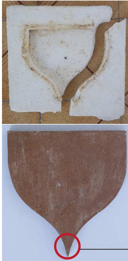
Figura 26: Problemas específicos encontrados no processo de confecção dos moldes.
