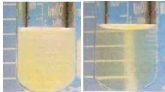
Figura 1.2: à esquerda à uma temperatura de 145^{\circ}\text{C} e 179^{\circ}\text{C} (aspecto leitoso fase líquida cristalina) e à direita é Benzenoato de Colesterila acima 179^{\circ}\text{C} (fase Líquida) [70].
