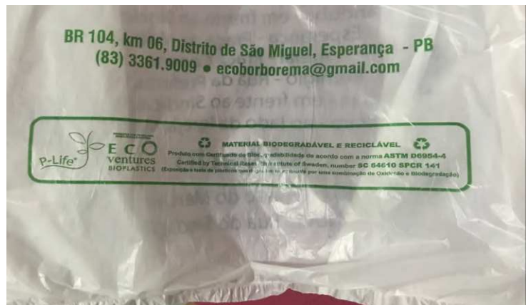
Figura 14: Sacola plástica biodegradável feita com aditivo P-life Fonte: Arquivo pessoal
