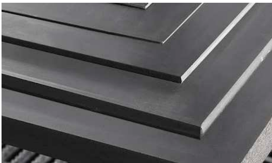
▲ Figura 68: Chapas de aço inox 304 (Fonte: Losinox, 2021)
