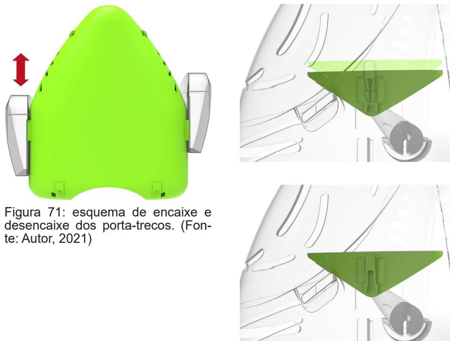
Figura 71: esquema de encaixe e desencaixe dos porta-trecos. (Fonte: Autor, 2021)
