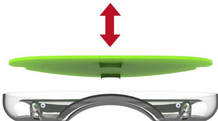
Figura 70: esquema de apoio da bandeja de detritos na base. (Fonte: Autor, 2021)
