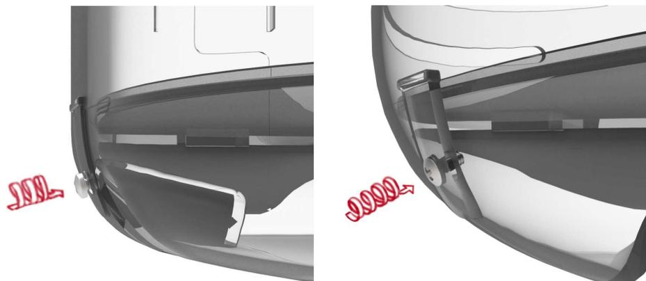
Figura 67: Esquema de fixação das carcaças à base. (Fonte: Autor, 2021)
