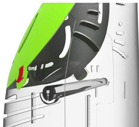
Figura 68: Esquema de desencaixe da tampa. (Fonte: Autor, 2021)
