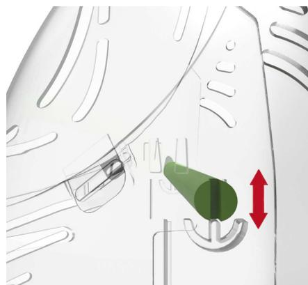
Figura 69: Esquema de encaixe e desencaixe do tarugo. (Fonte: Autor, 2021)
