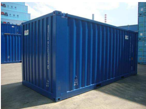
Figura 4 Container de 20 pés tipo DRY
