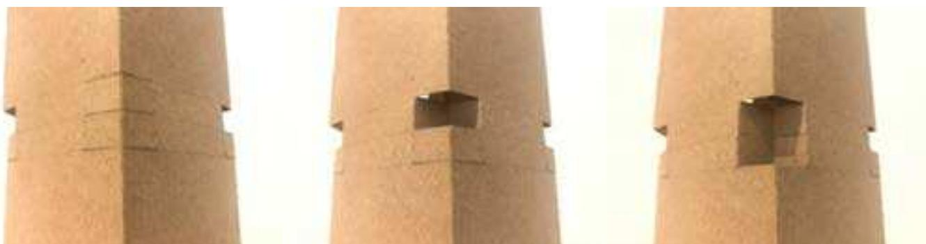
Figura 43: Vista exterior dos diferentes estágios do sistema de travas da solução Nº 1.1 para fixação das plantas no interior da embalagem. (Fonte: Elaborado pelo autor).
