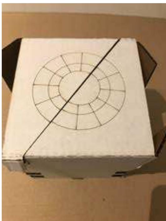
Figura 61: Face superior do berço. As linhas que desenhavam os círculos são destacáveis, permitindo a adaptação da peça à diferentes plantas. (Fonte: Elaborado pelo autor).
