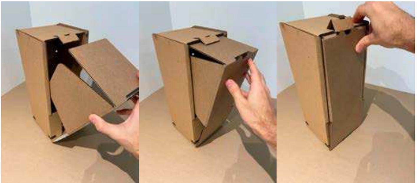
Figura 57: Fechamento da "tampa" da caixa. As abas da estrutura menor encontram apoio no interior da caixa, fortalecendo toda a estrutura. (Fonte: Elaborado pelo autor).
