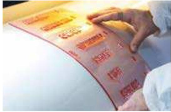
Figura 30: Processo de flexografia com clichê. (Fonte: upaper.com.br).
