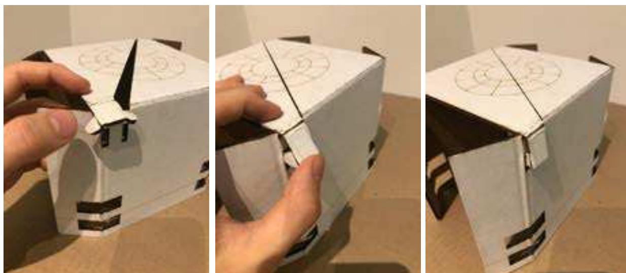
Figura 62: Funcionamento do encaixe do berço em formato de "T". (Fonte: Elaborado pelo autor).
