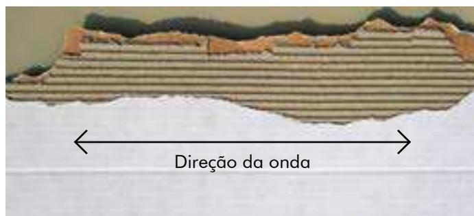
Figura 23: Direção da onda do papelão. (Fonte: Adaptado de upaper.com.br).
