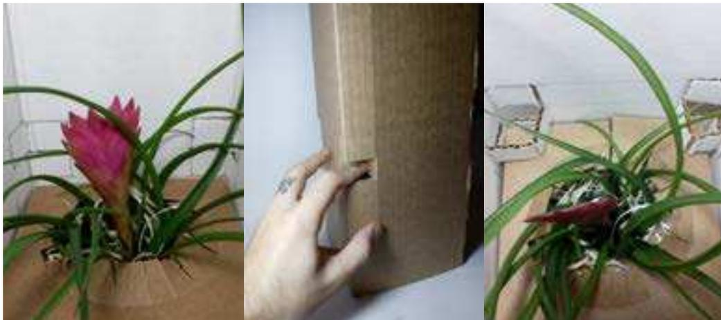
Figura 36: Funcionamento da trava: 1 - posicionar a planta com a tampa de kraft dentro da caixa; 2 - Empurrar as travas para dentro. (Fonte: Elaborado pelo autor).
