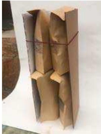
Figura 13: Teste de cubagem com Sacos de substrato (Fonte: Elaborado pelo autor).
