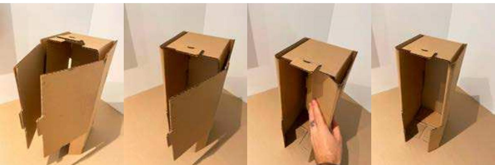
Figura 56: Abas laterais da estrutura maior oferecendo um reforço às paredes da estrutura. (Fonte: Elaborado pelo autor).
