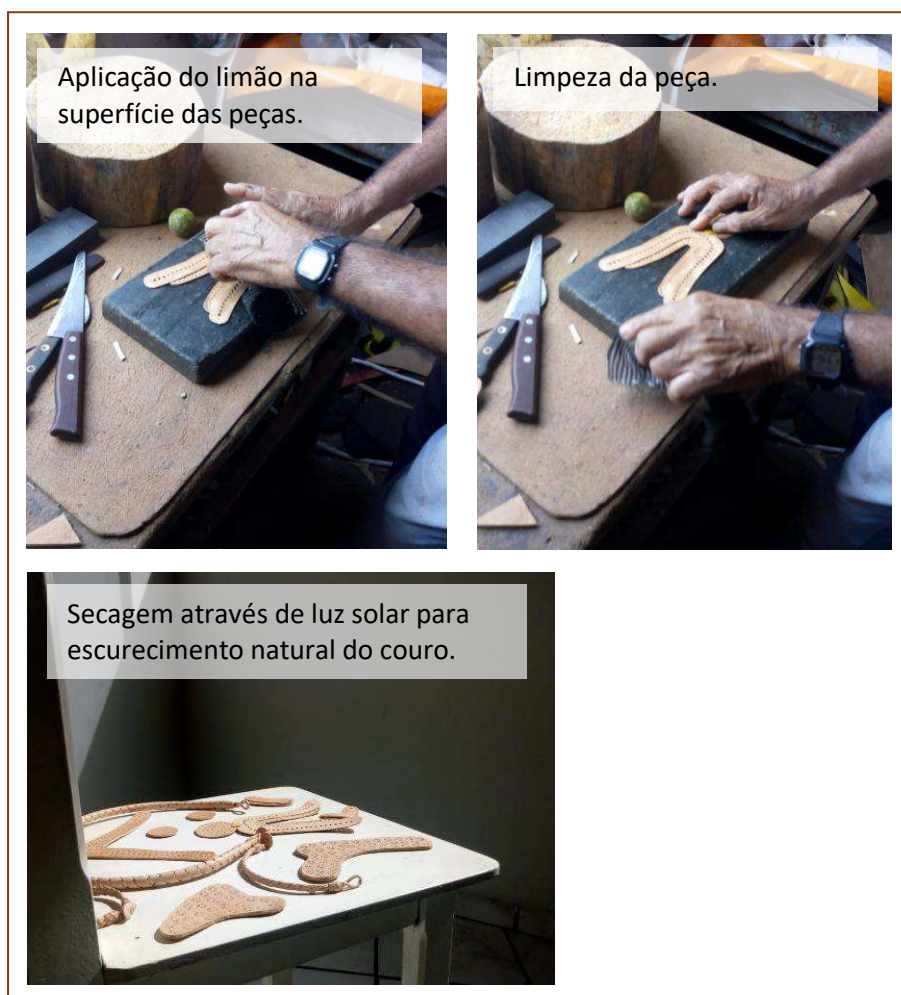
Figura 52. Processo de coloração das peças.
