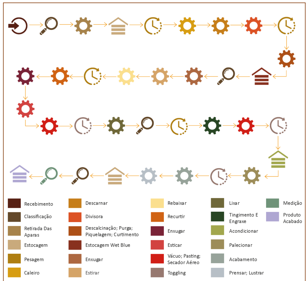
Figura 24. Fluxograma do couro adaptado de Cândido Filho (1999).
