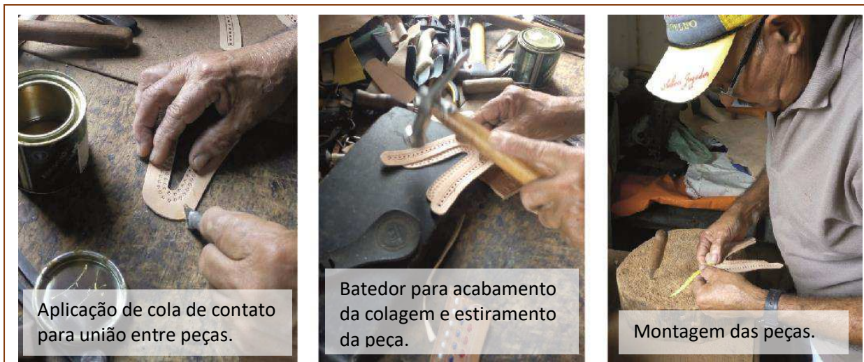
Figura 51. Processos de colagem e montagem.
