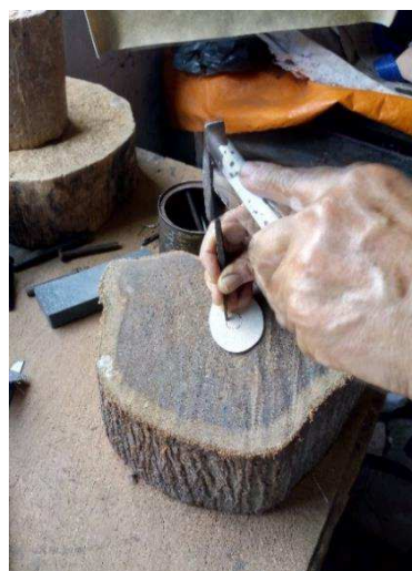
Figura 44. Execução do furo de uma das peças dos gabaritos.
