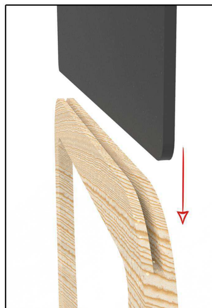
Figura 58: Detalhe do sistema de encaixe da lousa na estrutura Fonte: do autor, 2018
