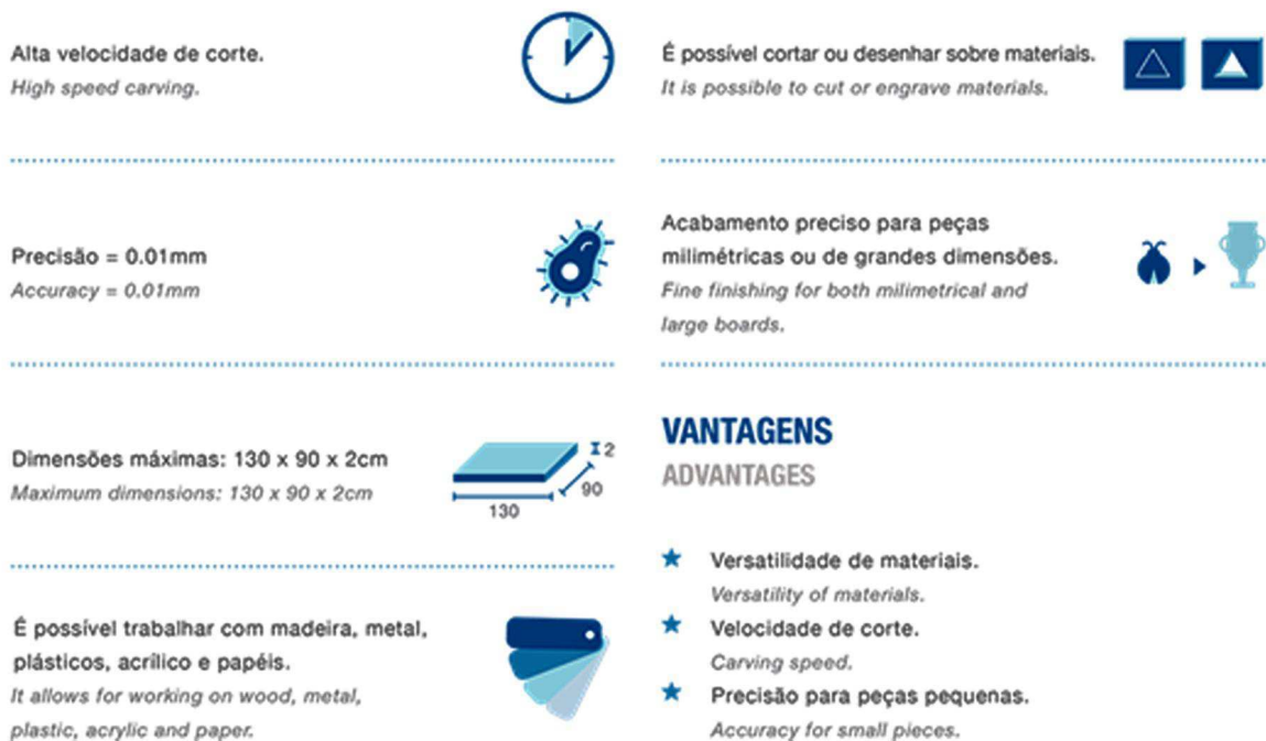
Figura 10: Infográfico do processo de corte a laser CO 2 Fonte: industria hoje.com.br Acesso em Outubro de 2018
