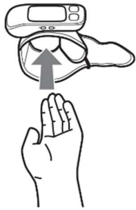
Figura 2 - Primeiramente deve-se colocar o aparelho no pulso com o visor/display voltado para cima.
