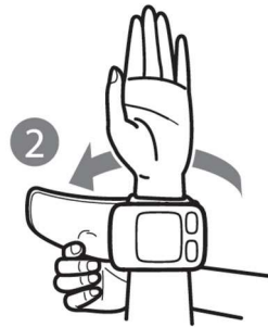
Figura 5 - Para fixar a braçadeira deve-se dobrar a extremidade para esquerda afim de prendê-la com o velcro (2).
