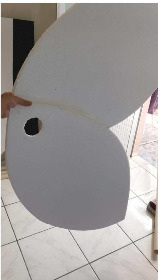
Porém o percebeu-se que não seria possível que fossem duas peças separadas, já que ficaria um relevo na peça. Isto seria um impecílio para o uso efetivo de todo o espaço da mesa. Desta forma uniu-se as duas peças para que o tampo fosse formado de uma peça única.
