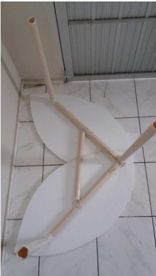
Quanto a estrutura, a mesma foi dimensionada a partir das medidas do tampo, os pés foram dispostos de maneira que o peso do tampo fosse distribuído igualmente entre os três.
