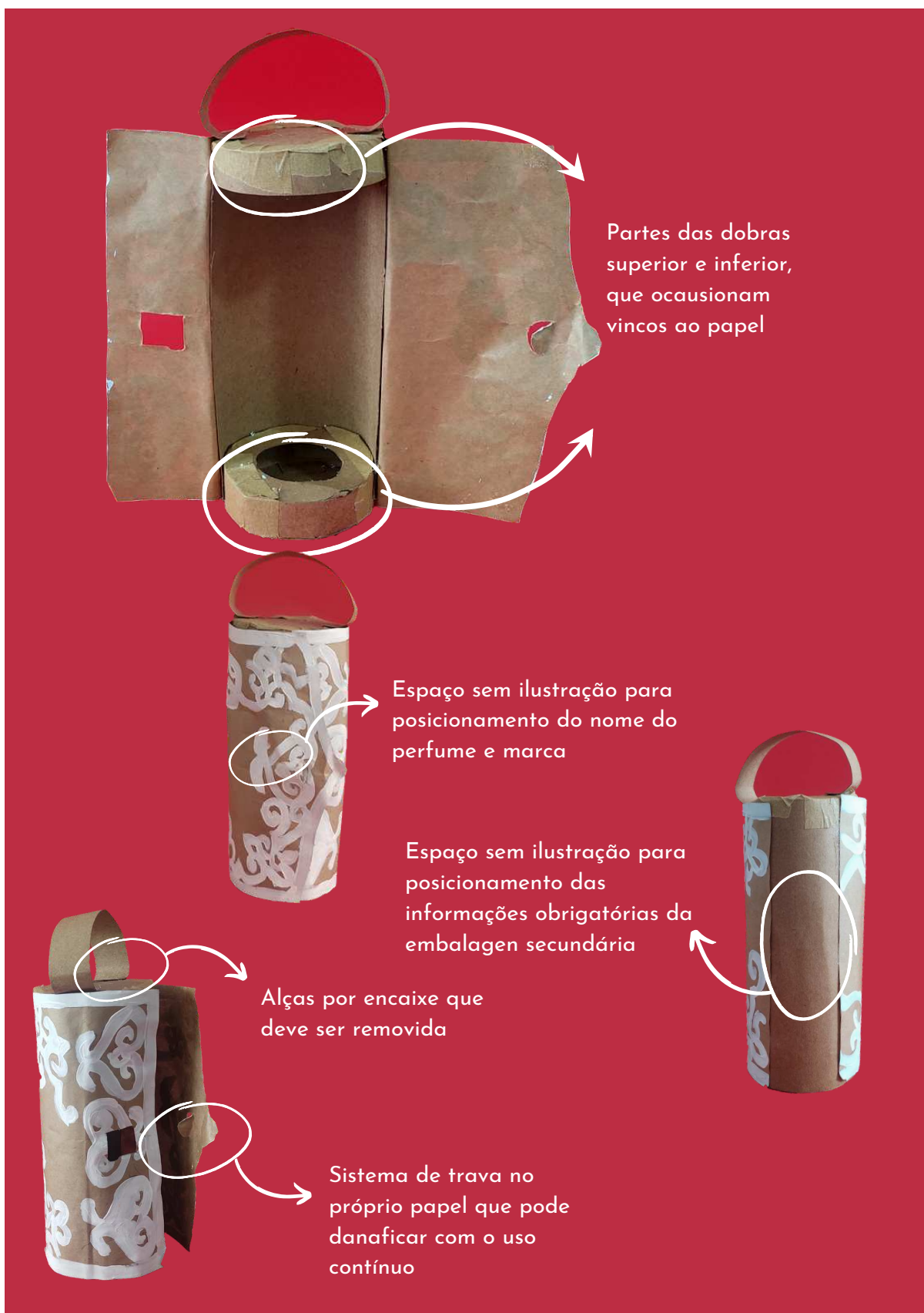
Figura 31: Esquema de alterações na embalagem secundária para o processo de refinamento.
