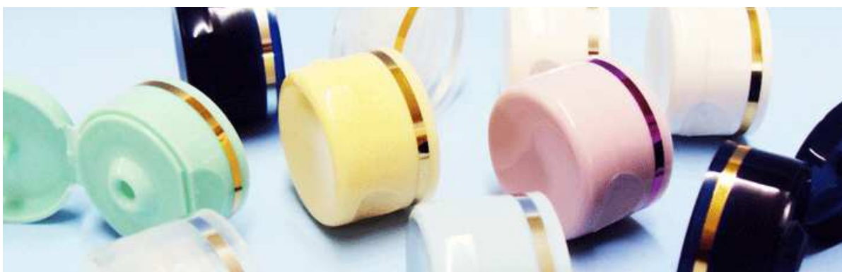
Figura 56: Gravação em Hot Stamping.
