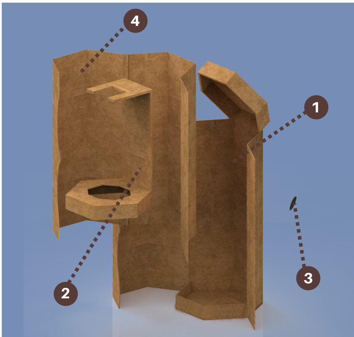
Figura 50: Perspectiva explodida embalagem secundária.
