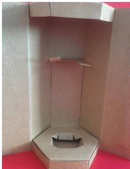
Figura 40: Detalhe do berço da embalagem secundária.
