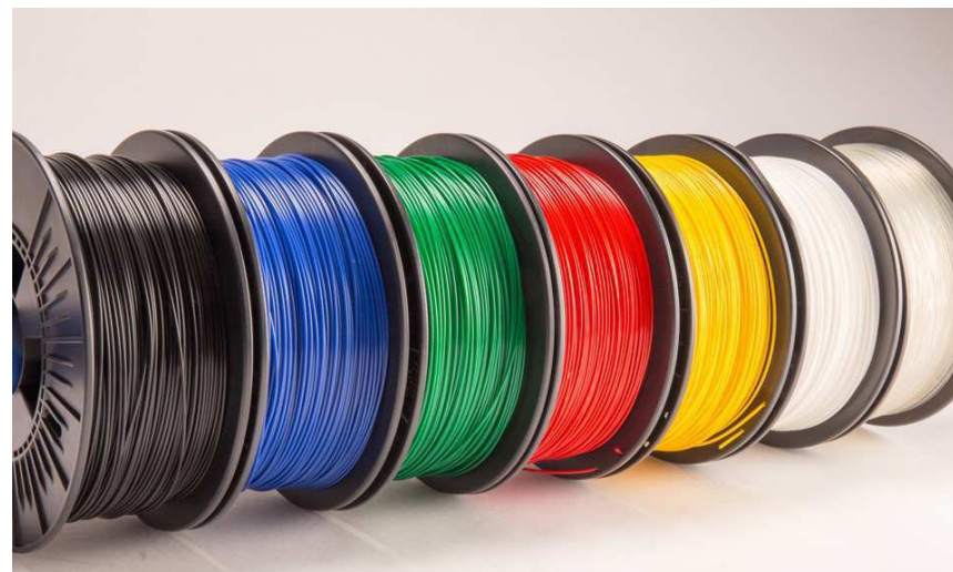
▲ Figura 52: Filamentos de P.L.A, material largamente utilizado em impressões 3D. (Fonte: Revista Amazônia, 2021.).
