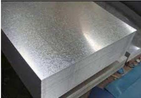
Figura 24: Chapa de aço galvanizado. (Fonte: Google)
