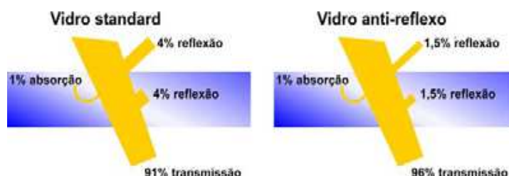
Figura 2.2.20 - Tratamento anti reflexo. (Fonte: Energia Solar Térmica, 2004)
