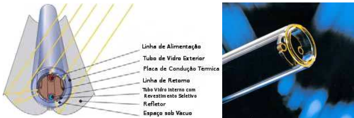
Figura 2.2.14: Tubo sob vácuo. (Fonte: Energia Solar Térmica, 2004)
