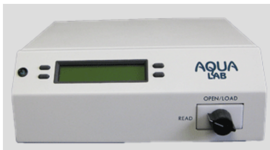
FIGURA II.1 – Aparelho utilizado para determinar a atividade de água.
