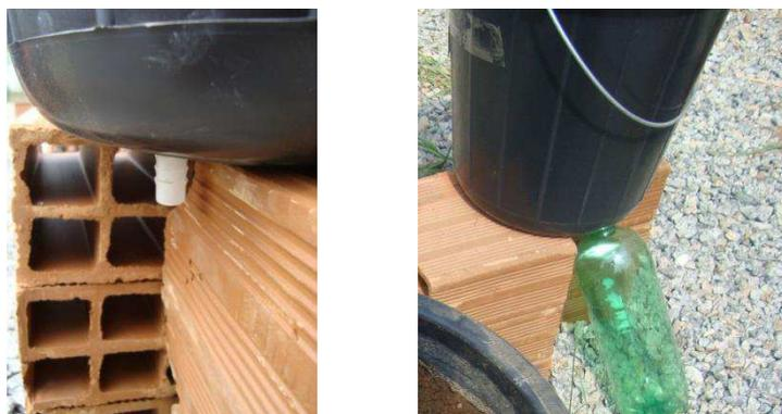
Figura 3. Sistema de drenagem utilizado no experimento.
