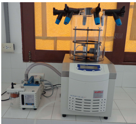
Figura 3.3 - Liofilizador utilizado para secagem das formulações dos preparados sólidos para iogurte de manga
