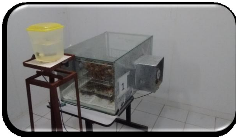
Figura 2. Esquema de instalação da minicâmara no interior da câmara climática
