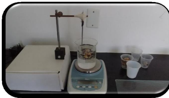
Figura 5. Aparelho adaptado utilizado na determinação da gravidade específica dos ovos
