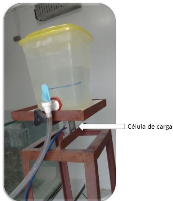
Figura 8. Bebedouro disposto com célula de carga para aferição do consumo de água pelas aves
