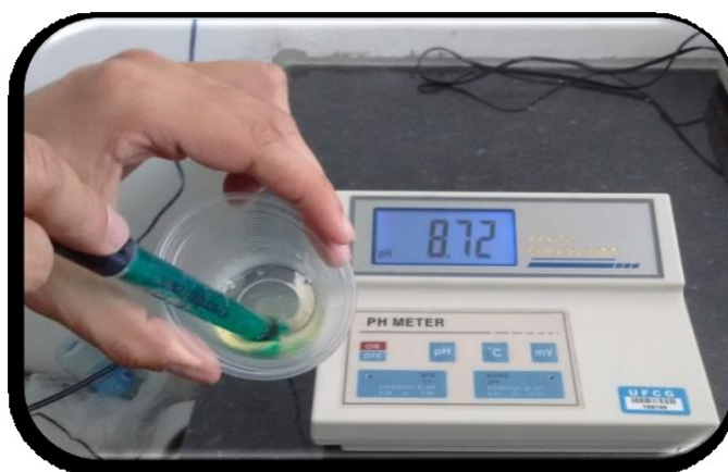
Figura 6. Determinação do pH do albúmen com a utilização do pHmetro
