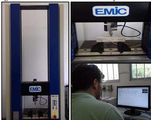
A resistência a tração na flexão ( $R_{t,f}$ ) é a média das resistências individuais, desconsiderando os valores discrepantes se o desvio absoluto máximo estiver acima de 0,3 MPa, conforme determinado na Norma Técnica 13.279 (ABNT, 2005). A resistência individual é calculada utilizando a Equação 10:
