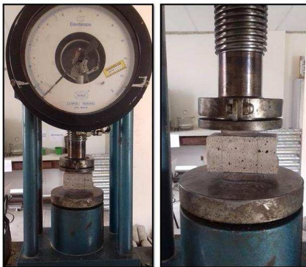
Para este experimento foram utilizadas as metades dos prismas oriundos do ensaio de resistência à tração na flexão e para cada prisma rompido no ensaio por flexão foram obtidos 2 (duas) amostras para os experimentos de resistência à compressão. Este experimento foi realizado, portanto, utilizando um conjunto de 06 (seis) prismas para cada tratamento de argamassa estudada.
