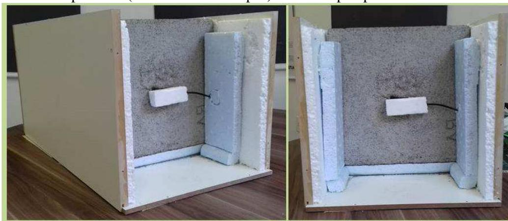
**Figura 20** – Vista superior da Câmara de fluxo térmico com a placa de argamassa
