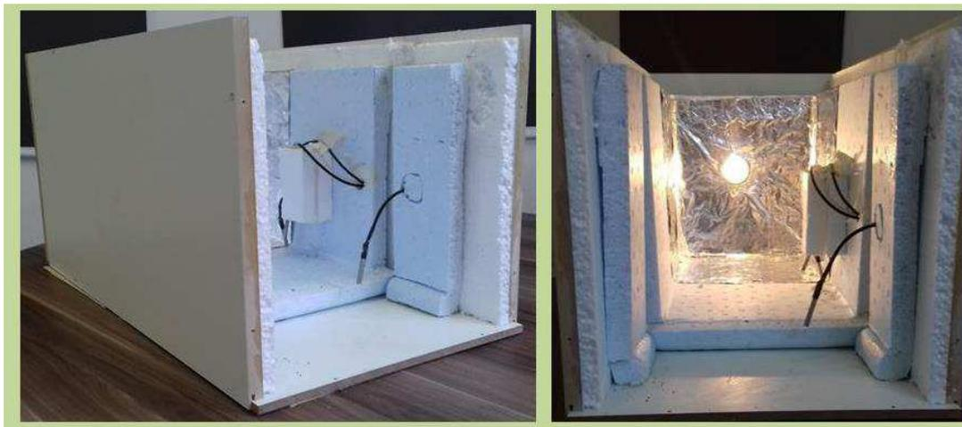
**Figura 18** - Câmara de fluxo térmico com a placa de argamassa e sensores de medição e temperatura, sem silicone e isopor. Vista em perspectiva e frontal
