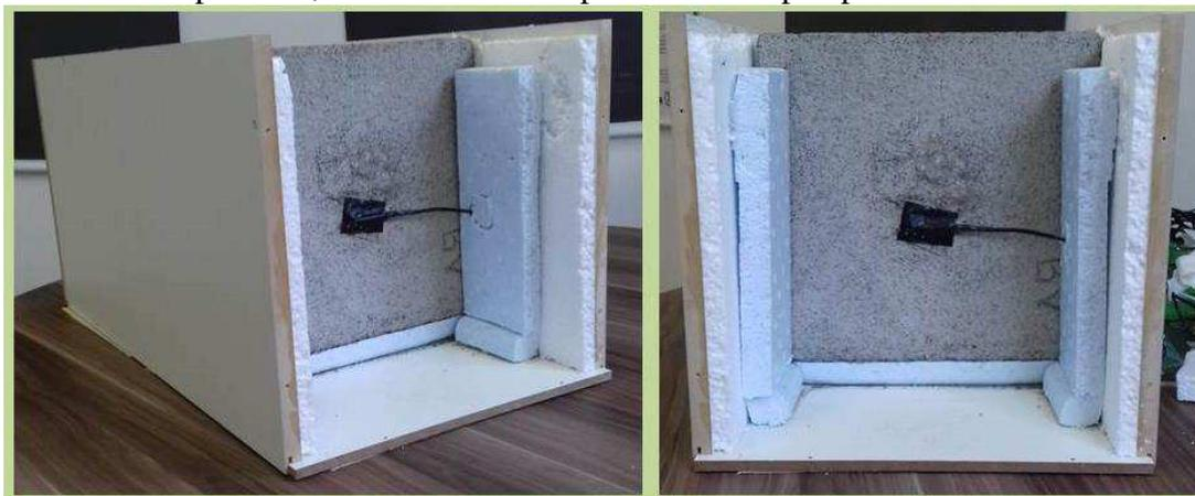
**Figura 19** - Câmara de fluxo térmico com a placa de argamassa, sensores de medição e temperatura (com silicone e isopor) Vista em perspectiva e frontal.
