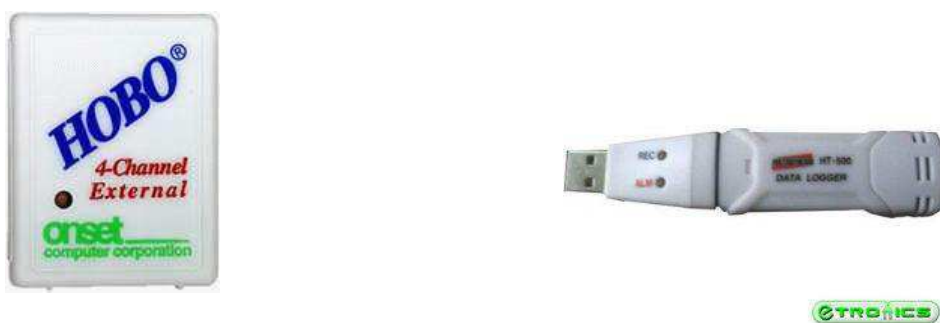
Figura 6 e 7. Datalogger Hobo®, utilizado para coleta de temperatura de globo negro, e datalogger Instrutherm HT 500®, utilizado para coletas de temperatura ambiente, umidade relativa do ar, e temperatura de ponto de orvalho, respectivamente.
