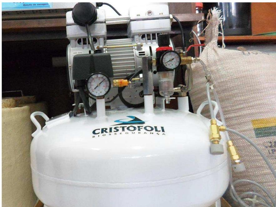
**Figura 6:** Compressor utilizado na aplicação dos extratos na forma de vapor
