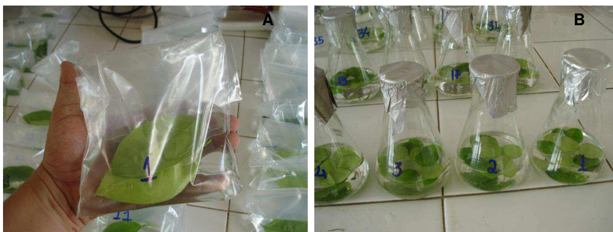
Figura 4. Determinação do teor relativo de água (A) e extravasamento de eletrólitos (B) nas folhas de citros. Campina Grande, PB, 2014.
