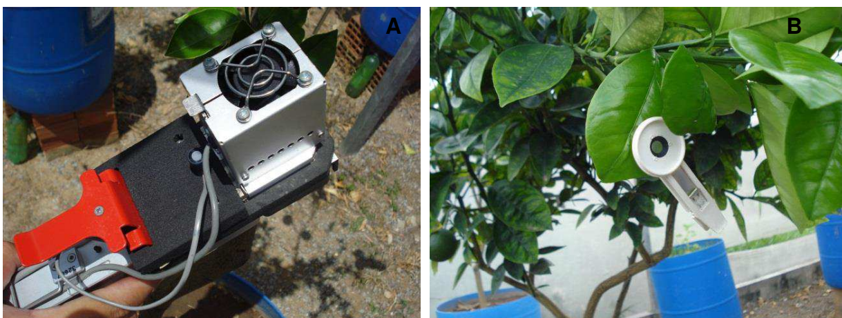
Figura 6. Determinação de trocas gasosas (A) e da fluorescência da clorofila a (B). Campina Grande, PB, 2014.
