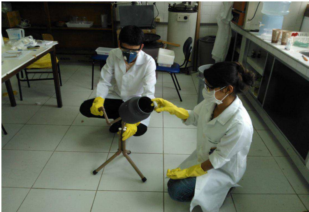
Figura 5.3. Aplicação dos materiais de revestimento/tratamento
