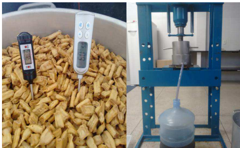
Figura 3. 5: Hidratação e prensagem das vagens
