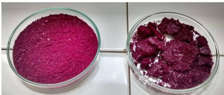
**Figura 3.2** – Amostras do pó, após 10 dias de armazenamento, com adição de maltodextrina (foto à esquerda) e sem adição (foto à direita).
