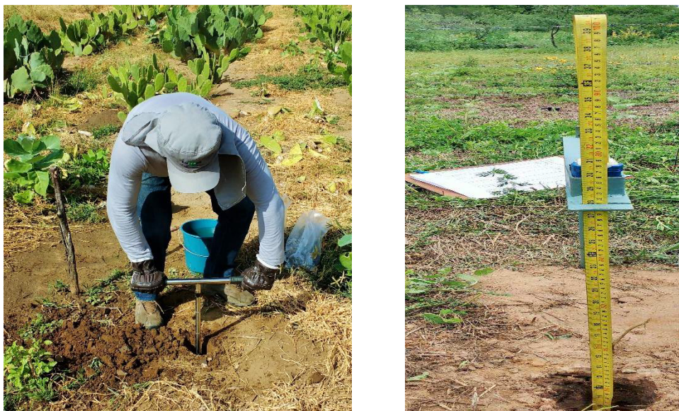
Figura 10. Procedimentos para realização do teste de condutividade hidráulica do solo, perfuração do poço utilizando trado (a) e acompanhamento do rebaixamento do nível de água no poço (b).
