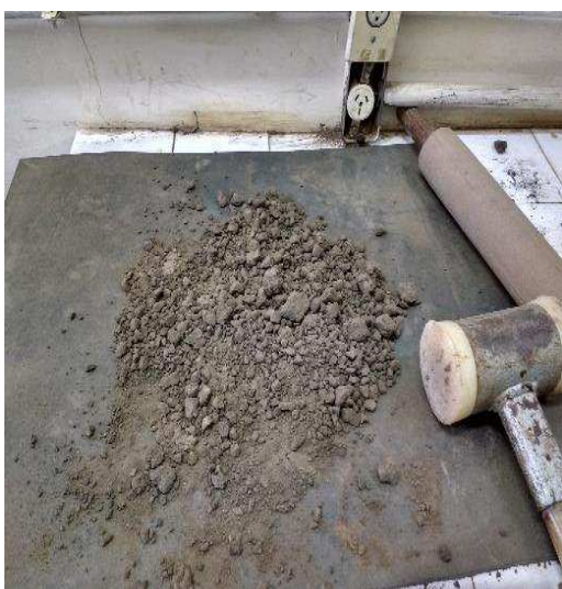
Figura 6. Trado holandês utilizado para perfuração dos poços e coleta das amostras de solo (a), saco plástico utilizado para o acondicionamento das amostras (b), destorroamento (c) e peneiramento das amostras de solo (d).
