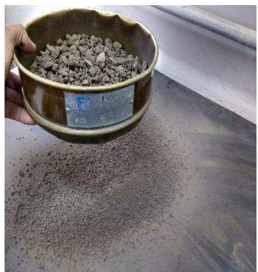
Figura 6. Trado holandês utilizado para perfuração dos poços e coleta das amostras de solo (a), saco plástico utilizado para o acondicionamento das amostras (b), destorroamento (c) e peneiramento das amostras de solo (d).
