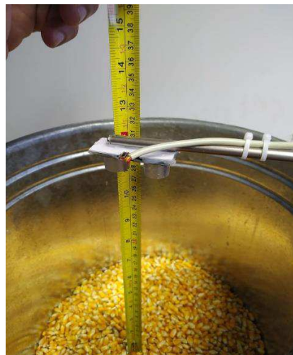
Figura 10. Calibração do sensor de nível de grãos.
