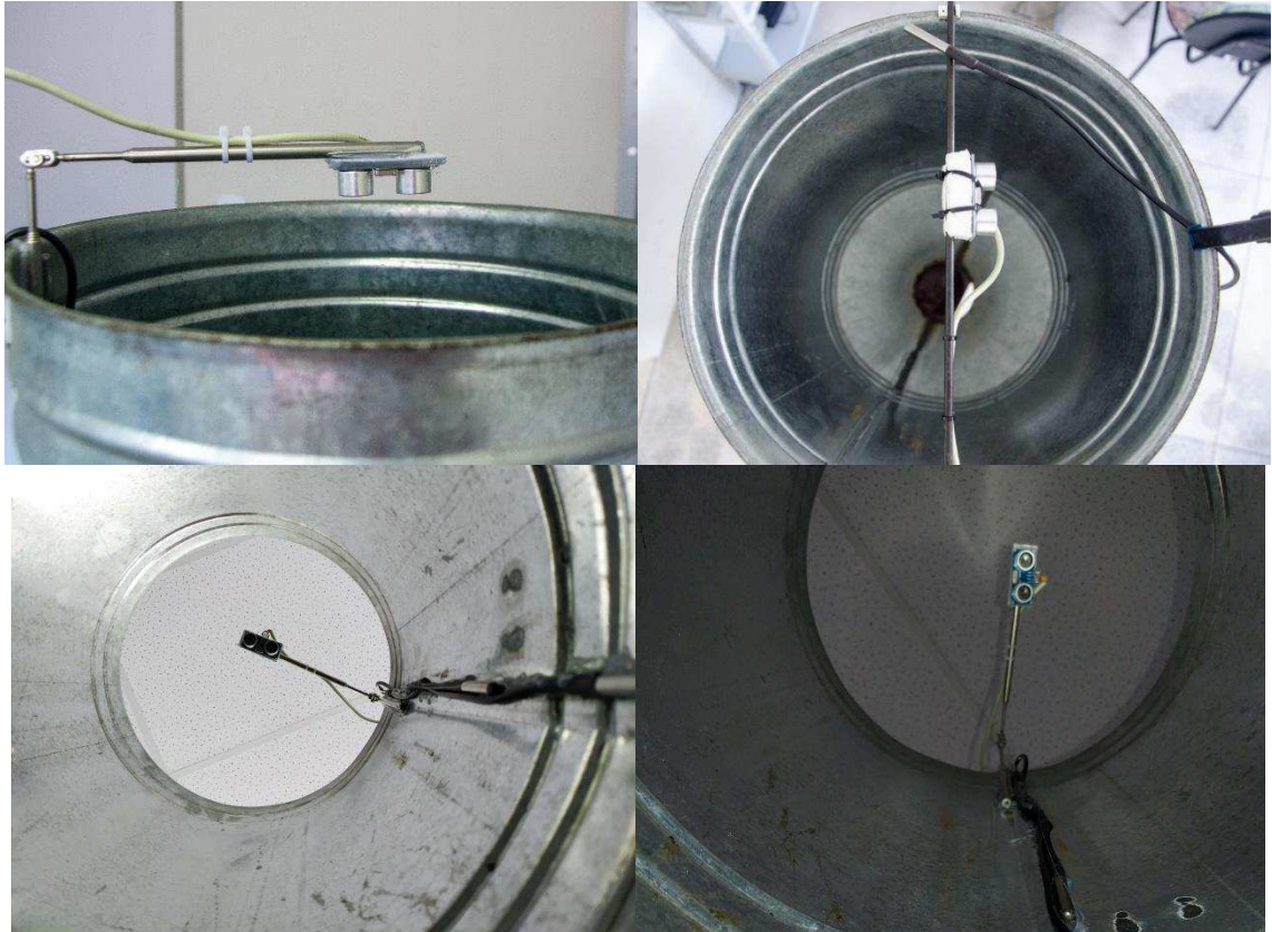
Figura 25. Sensor de nível de grãos.
