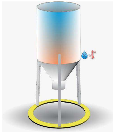
Figura 5. Disposição dos sensores de umidade no silo.
