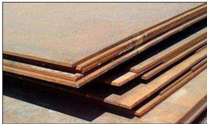
Figura 20 - Chapa de aço ARBL API 5L X70.
