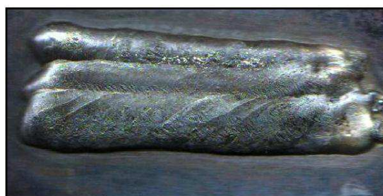
Figura 28 - Revestimento Plasma Pó com três passes com sobre posição 1/2 .
