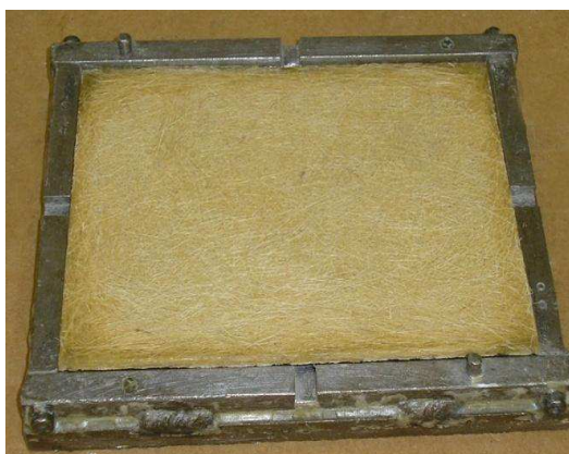
Figura 3.18 Compósito no molde; medição e preparação do corpo de prova.
