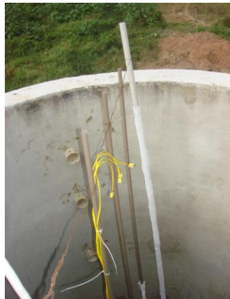
Figura 2. Disposição da instrumentação geotécnica na célula experimental.
