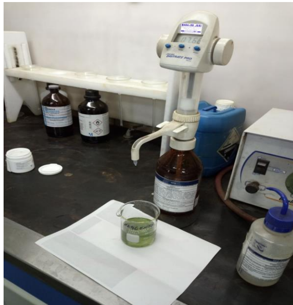
Figura 8. Amostra após titulação, com ponto de viragem de vermelho para verde.
