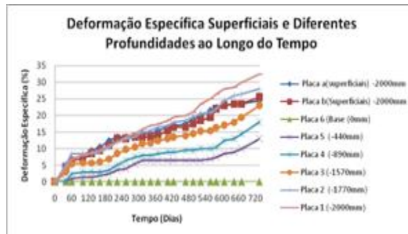
Figura 10. Deformação específica dos recalques superficiais e em profundidades ao longo do tempo.
