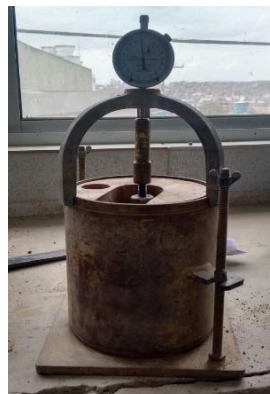
Figura 3. Corpo de prova moldado na umidade ótima para ensaio de ISC.
