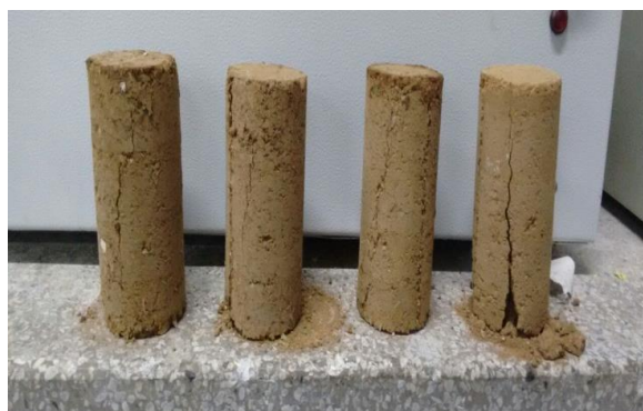
Figura 6. Amostras fissuradas (10, 7, 5% PET e solo-cimento, respectivamente).
