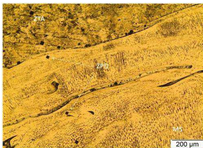
Figura 44: Micrografia apresentando metal de solda, zona parcialmente diluída (ZPD) e a ZTA do revestimento SAW – 9. Ampliação: 100x.
