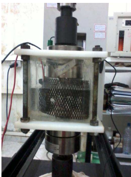
Figura 21 – Esquema da célula de dopagem que será utilizada no ensaio de tração.
