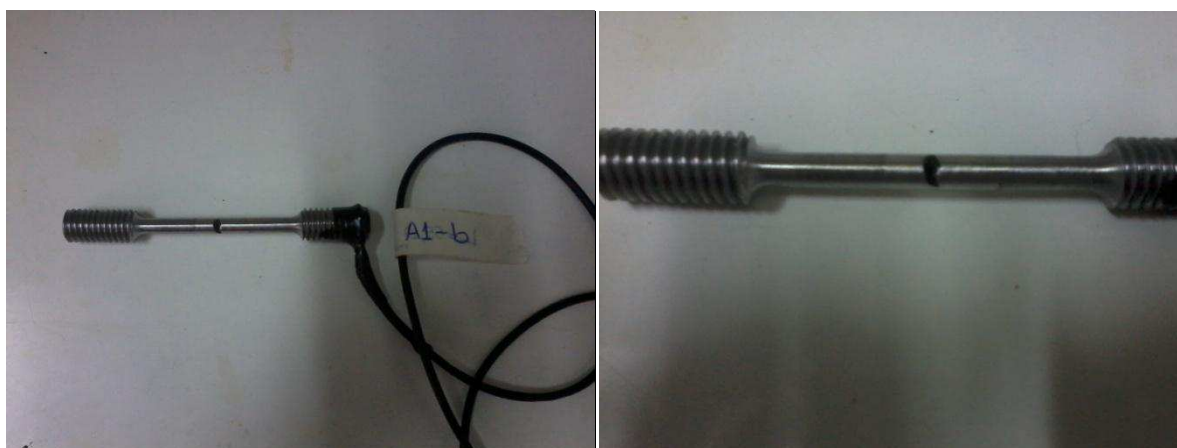
Figura 18 – Presença de descontinuidades no corpo de prova para ensaio de tração.
