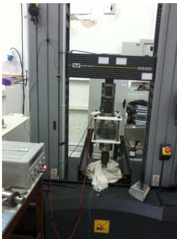
Figura 20 – Montagem do ensaio de tração com o meio.
