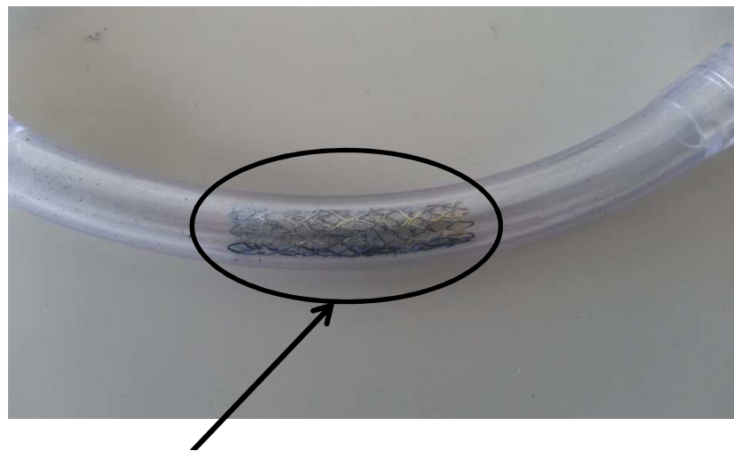
Figura 4.54 – Stent inserido no tubo - Expandido
