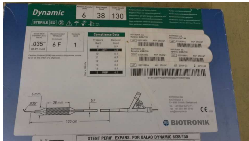
Figura 4.51 – Embalagem do Stent utilizado no ensaio com os dados técnicos
