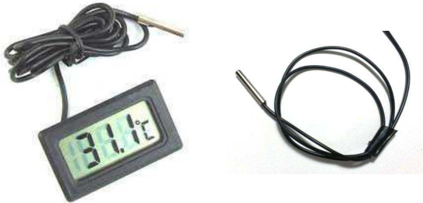
Figura 4.24 – Sensor de temperatura - termorresistência
