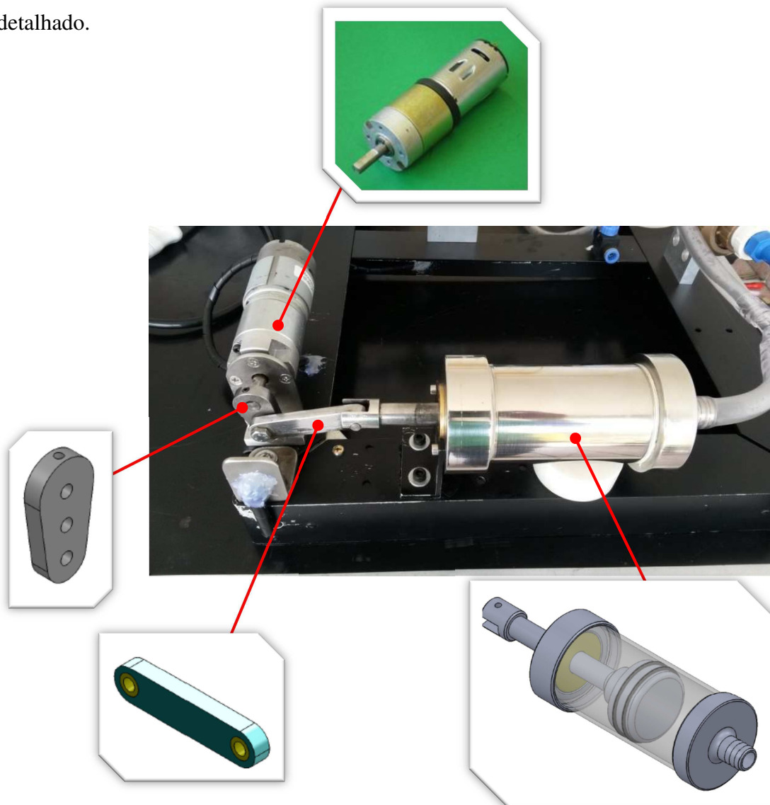
Figura 4.17 – Subsistema gerador de pulso
