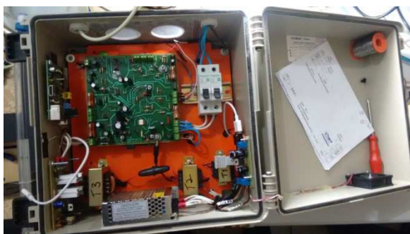
Figura 4.34 – Montagem do sistema eletrônico na caixa de proteção
