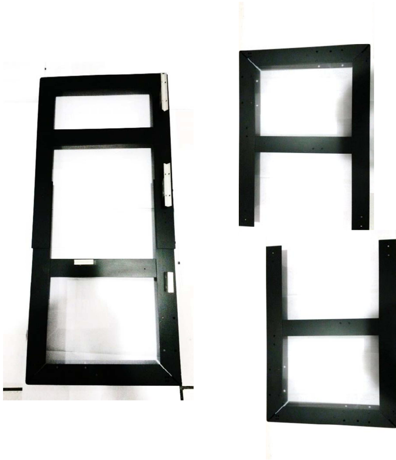
Figura 4.10 – Estrutura da bancada em cantoneira de alumínio – Perfil “L”
