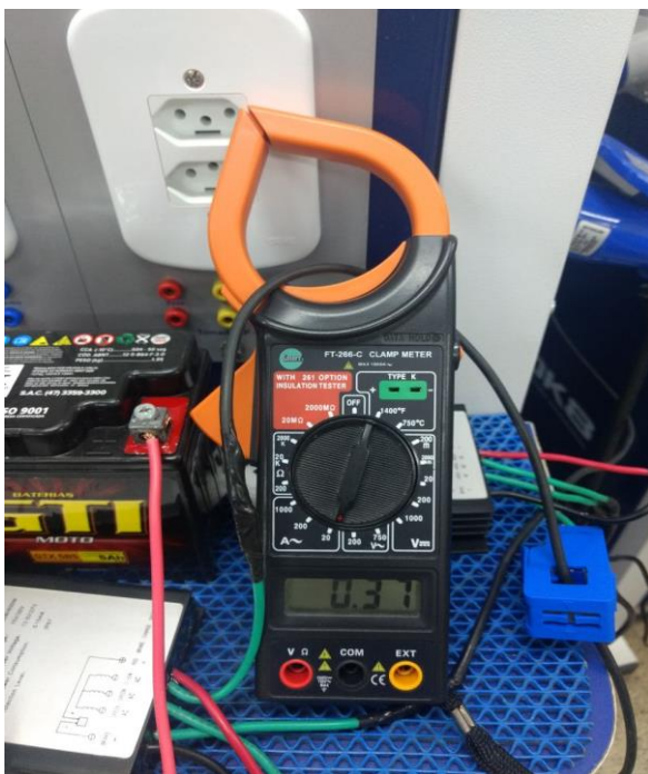
Figura 6. Medição da corrente elétrica.
