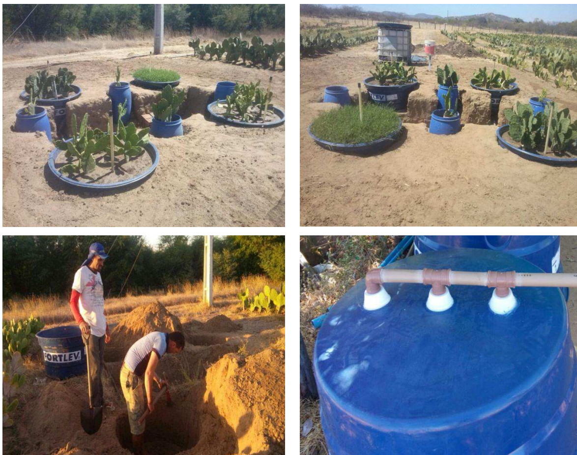
Figura 13. Esquema da instalação dos lisímetros de drenagem para as cultivares de palma forrageira na área experimental. Santa Luzia-PB.
