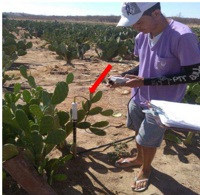
Figura 5. Monitoramento do conteúdo de água no solo por meio da Sonda de Capacitância FDR. Santa Luzia-PB.
