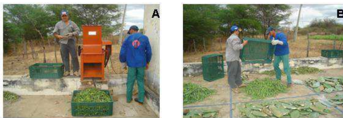
Figura 10 Forrageira fatiadoura da palma (A), Terraço para secagem da palma ao sol na Fazenda NUPEÁRIDO (B). PATOS-PB, 2008
