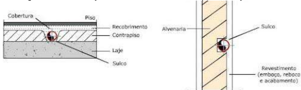
Figura 31 - Demonstração de como cortar as alvenarias para colocação de tubos.
