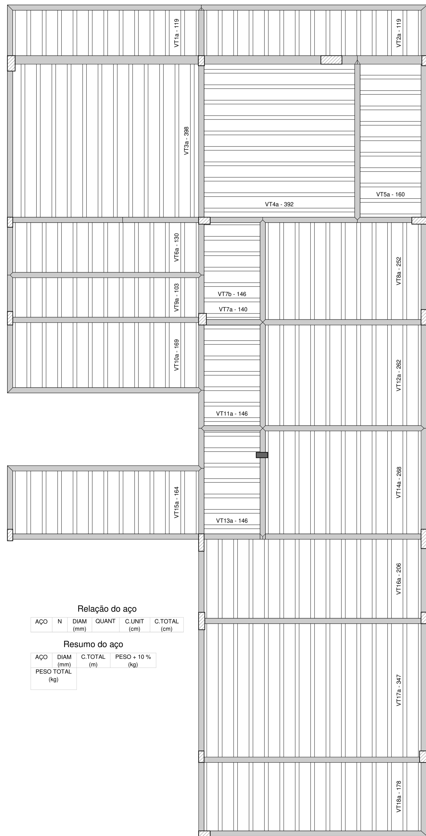
Planta de vigotas pré-moldadas
