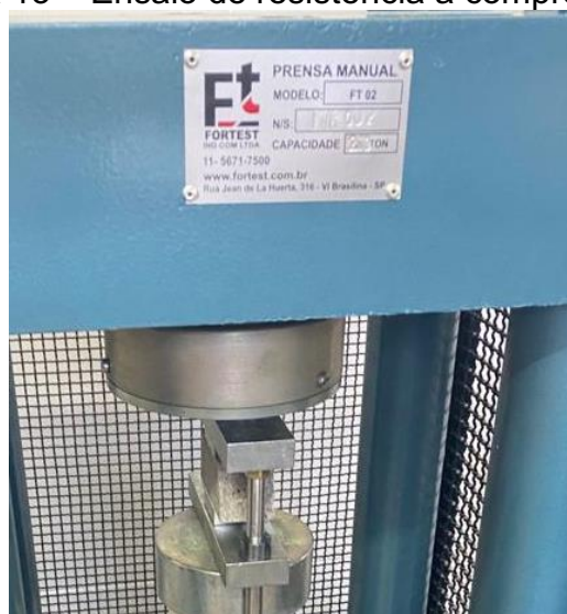
Figura 13 – Ensaio de resistência à compressão.
