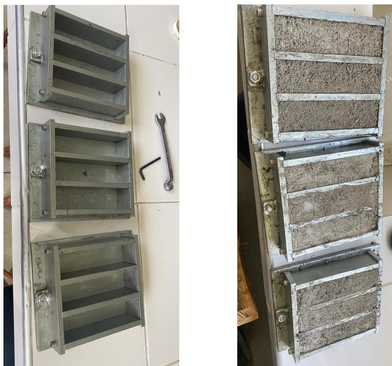
Figura 7 – Moldagem dos corpos de prova: (a) Lubrificação dos moldes; (b) Argamassas moldadas
