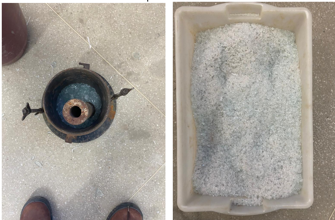
Figura 6 – Ensaio de Granulometria da do vidro: (a) Processo de tritura; (b) amostra após ser triturada
