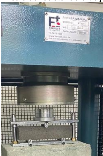
Figura 11 – Ensaio de resistência à tração na flexão.
