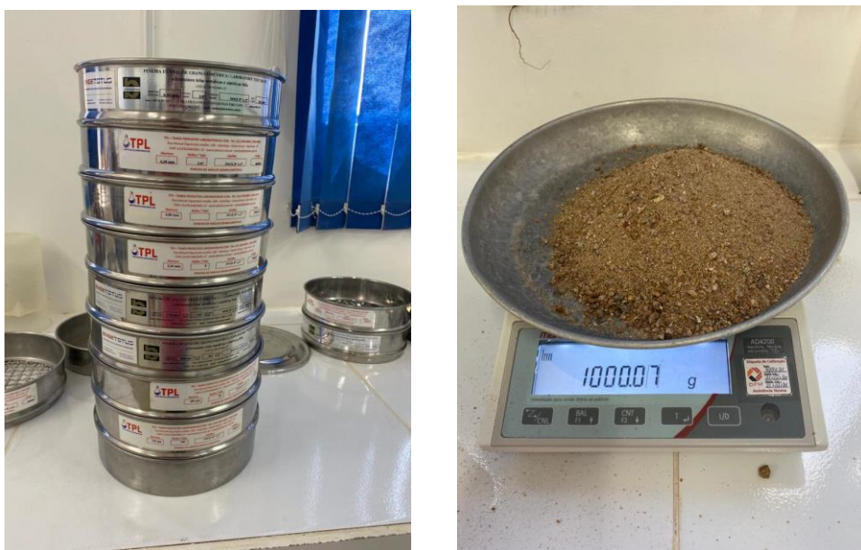
Figura 5 – Ensaio de Granulometria da areia: (a) Peneiramento; (b) Pesagem a mostra (a) (b)
