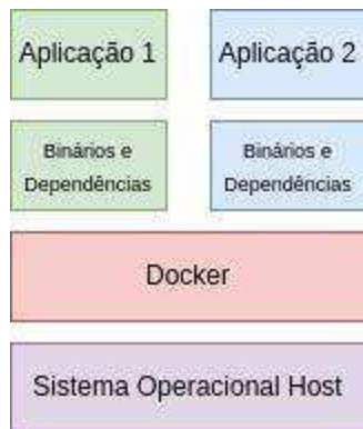
Figura 1: Diagrama de contêineres. Através do Docker, a aplicação 1 e a aplicação 2 podem compartilhar os recursos de hardware da máquina host e ainda assim funcionarem distintamente sem impactarem uma na outra.
