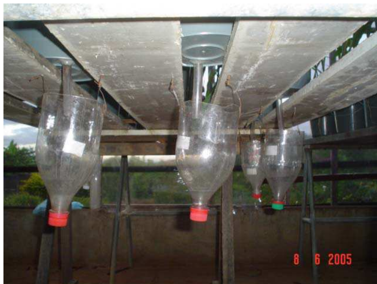
FIGURA 2 – Visualização dos coletores da água percolada (embaixo da bancada) instalados nos vasos que funcionaram como lisímetros de drenagem (tratamento 1T_1/2T_1 ).
