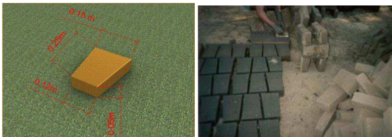
Figura 1. Formato e dimensões dos tijolos e processo de moldagem.
