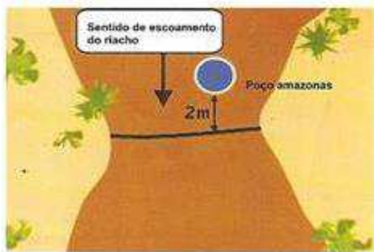
Figura 1. Local de instalação do poço Amazonas.
