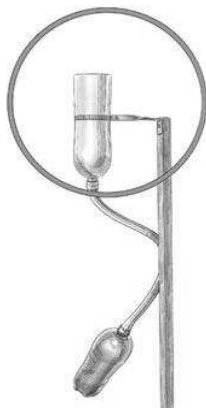
Figura 2. Montagem final do pluviômetro.
