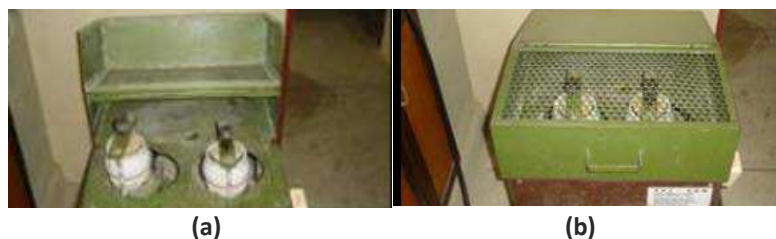
FIGURA 2 – MOINHO DE BOLAS: (A) POSICIONAMENTO DOS RECIPIENTES (B) EM FUNCIONAMENTO
