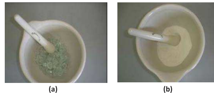
FIGURA 1 – APILOAMENTO DO VIDRO (A) ESTÁGIO INICIAL (B) ESTÁGIO FINAL
