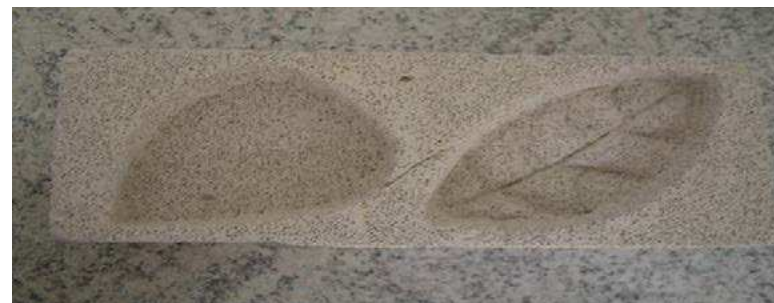
FIGURA 3 - MOLDES EM CONCRETO CELULAR PARA ACOMODAÇÃO DAS AMOSTRAS
