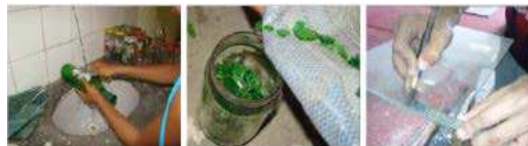
FIGURA 15 – LIMPEZA, TRITURAÇÃO E CORTE DOS RESÍDUOS VÍTREOS
