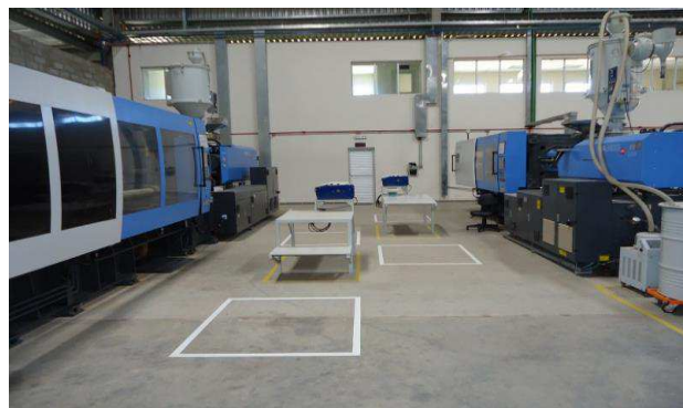
Figura 3b - Demarcações no piso
