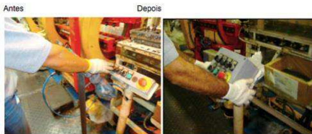
Figura 13: Melhoria na botoeira, evitando deslocamento do funcionário.
