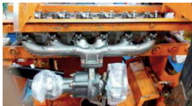
Figura 5: Montagem do coletor com a turbina.
