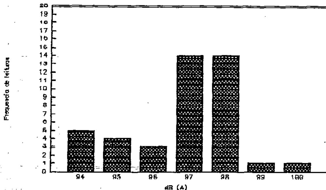
FIGURA 4.3 Comparação entre as freqüências de leituras de níveis de ruídos registradas durante a operação de sulcamento.
