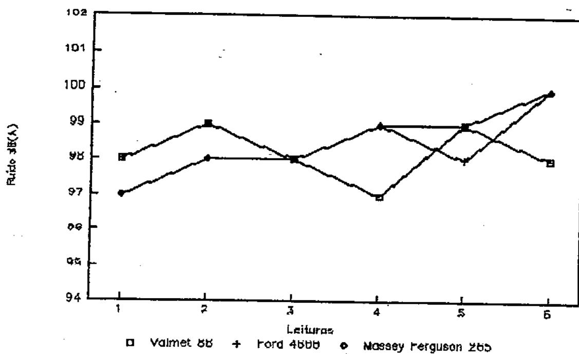
FIGURA 4.4 Comparação entre os níveis de ruídos emitidos pelos tratores utilizados, durante a operação de aração.
