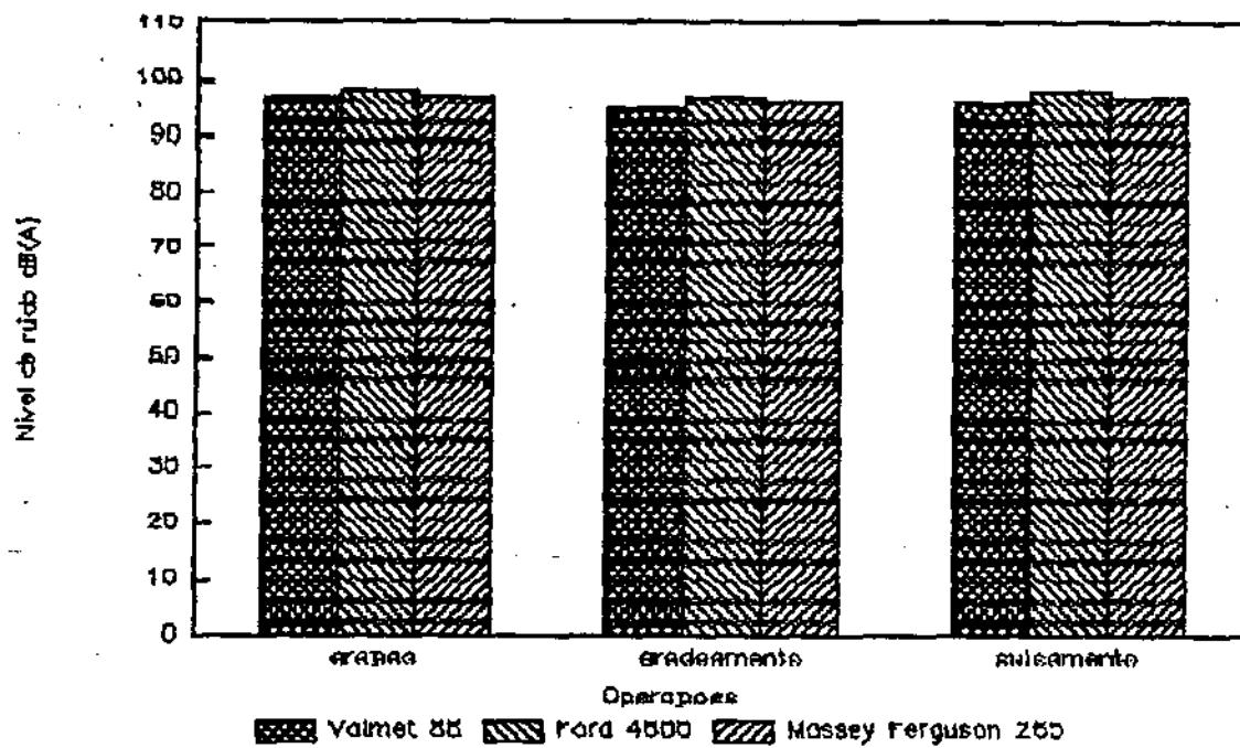
FIGURA 4.7 - Comparaçao entre os níveis de ruído médio emitidos pelos tratores utilizados durante a operacão de preparo periódico do solo. Utilizou-se a média entre as três leituras que apresentaram maior predominância de freqüência de leituras durante cada operacão de campo.
