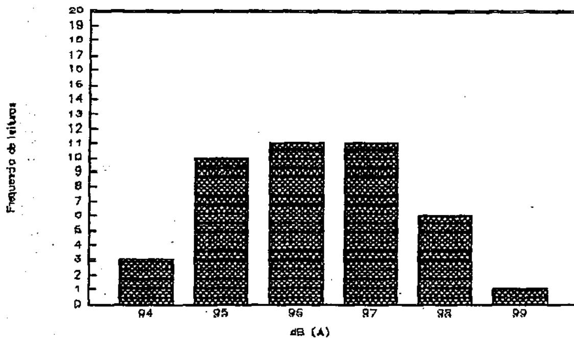
FIGURA 4:2 Comparação entre as freqüências de leituras de níveis de ruídos registradas durante a operação de gradeamento.
